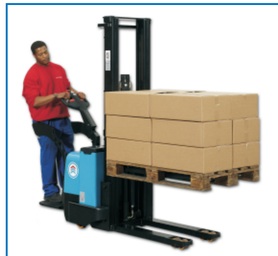
Der E-1232FH ist mit einem Vollfreihub von 1580mm ausgestattet.
