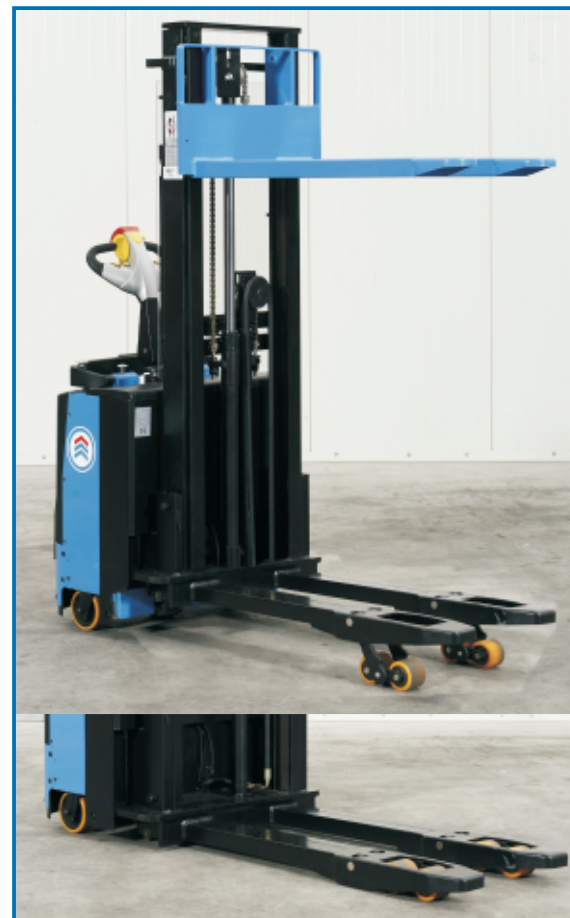
Mit dem Initialhub werden beim E-1032AFH die Gabelträger nach oben gefahren und die Bodenfreiheit des Staplers erhöht sich.
